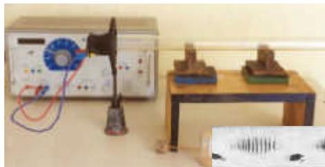
Links: Versuchsaufbau mit Kundtscher Röhre gleichmäßig gefüllt mit Korkpulver.
